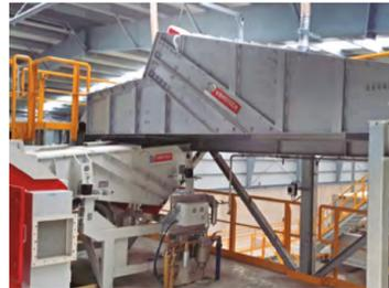
Schwingförderer mit Eigenfrequenz / Resonanz für den Schrotttransport
