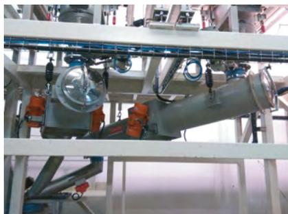
Convoyeur vibrant bi-directionnel
