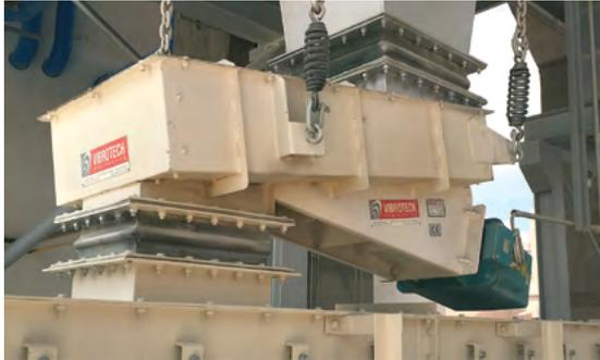
Extracteur de trémie électromagnétique
