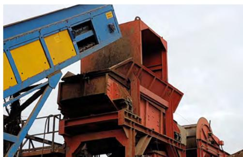
*Convoyeur doseur électromagnétique*
