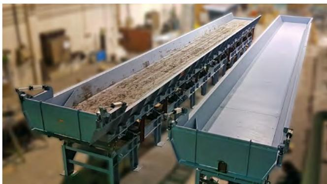
Convoyeur vibrant pour sable
