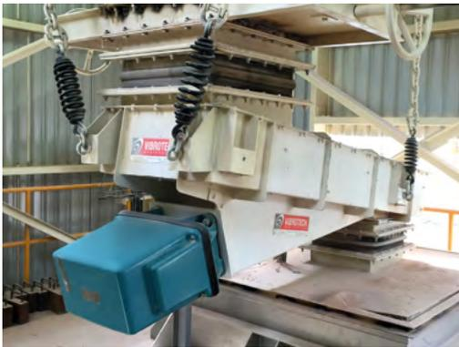
Extracteur de trémie électromagnétique
