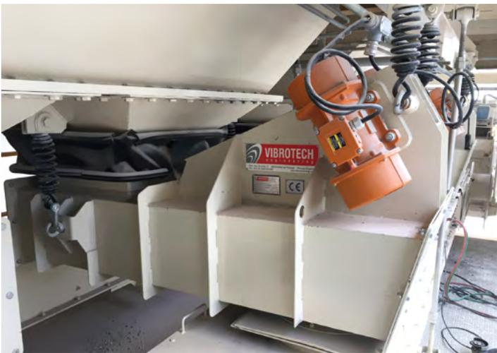
*Extracteur de trémie électromécanique*
