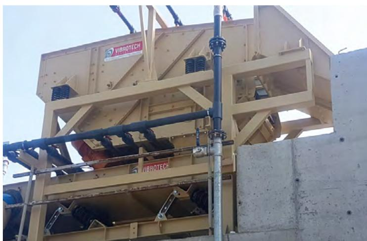
Les entraînements se font moyennant une boîte à engrenages entraînée par un moteur conventionnel ou par des vibrateurs électriques.
