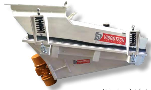
*Extracteur de trémie électromécanique*
