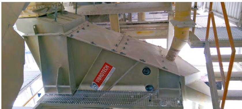
Les modèles standard présentent des largeurs de maille de 0,50 m, 1 m, 1,50 m, 2 m et 2,50 m. Deux séries sont disponibles : la série SS (série normale) et la série SLS possédant une maille 1 mètre plus longue pour accroître les débits sur une surface réduite.
