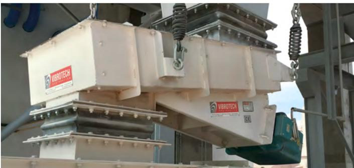
*Extracteur de trémie électromagnétique*
