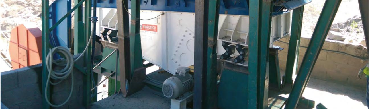
Im Allgemeinen werden sie zur Produktionsentlastung in Vorbrechmühlen und Backenbrechern eingesetzt, indem sie feines Material entfernen, bevor es in die Mühlen gelangt.
