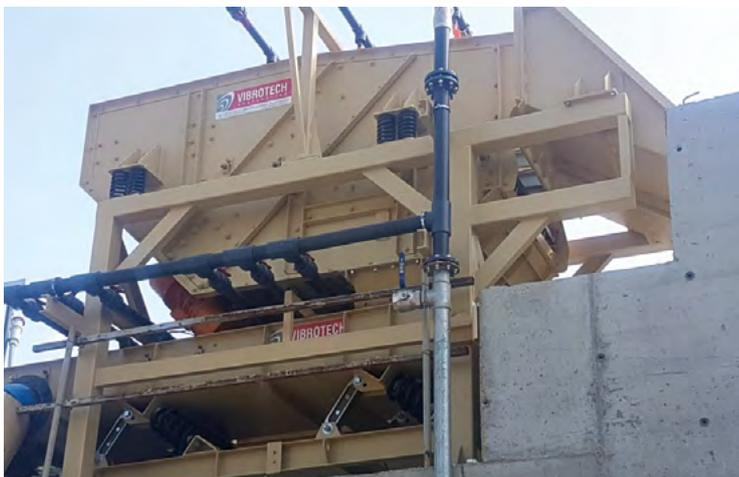
Die Vortrommelsiebe sind mit einer 400-HB-Verschleißschutzbeschichtung ausgestattet, die am Boden und an den Seiten der Maschine angeschraubt ist.
