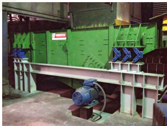
Récupération de sable sous convoyeur à bande synchronisé (SBC) et convoyeur automatique de moules (AMC)
