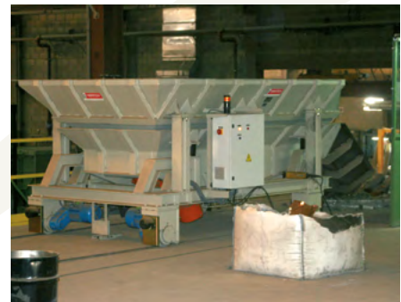
Chargeur de fours à induction
