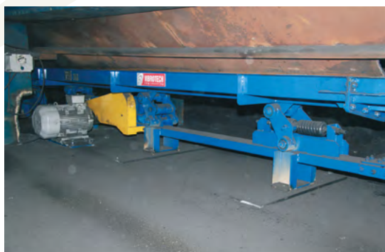
Récupération de sable sous convoyeur à bande synchronisé (SBC) et convoyeur automatique de moules (AMC)
